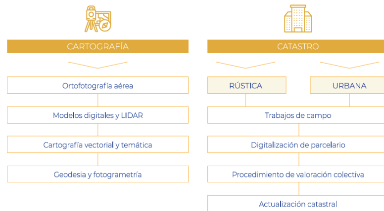
Figura 6. Modelo de trabajo división de Cartografía y Catastro
