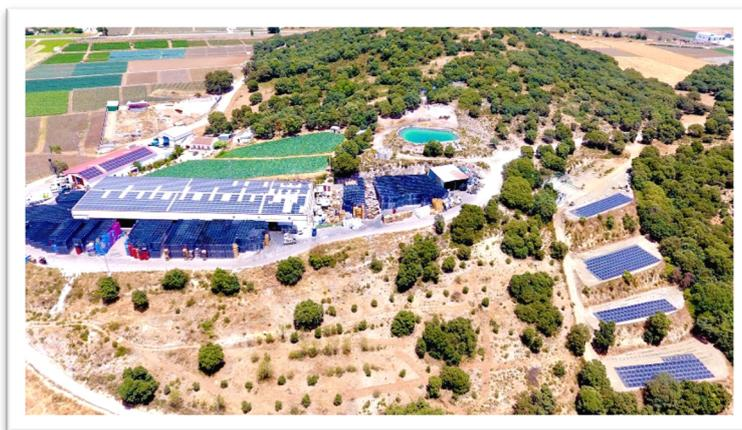
**BODEGA FAMILIA TORRES (TARRAGONA).** Instalación con integración arquitectónica en fachada. Potencia de 50,2 kWp y 135 paneles solares implantados. Con dicha instalación la cobertura del autoconsumo respecto del consumo total es del 34,15%.
